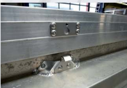
Aufnahmepunkte für das Riegelblech ...
